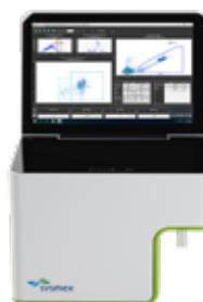
**Citómetro de flujo:** instrumento para la cuantificación de la concentración de células de levadura.
