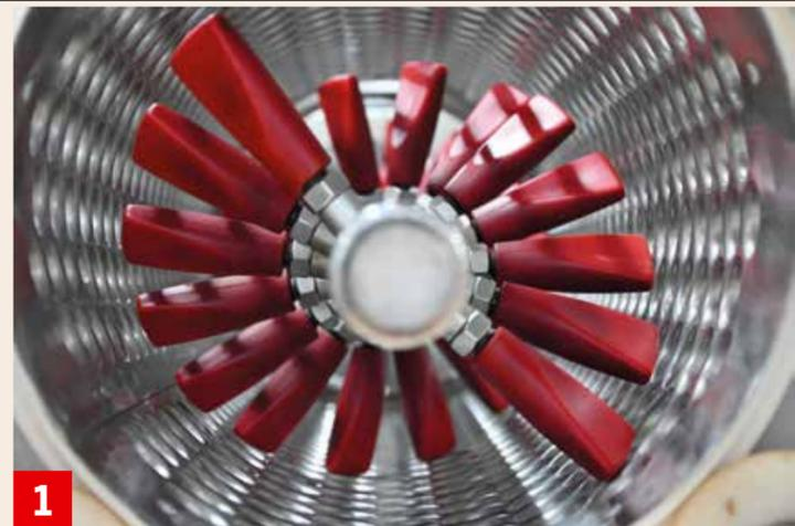
**1** Interno di una diraspa pigiatrice di piccole dimensioni. Particolare della gabbia forata in acciaio inox e dell'albero battitore con palette in gomma (Cantina Sperimentale Bonafous DISAFA).
