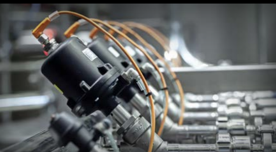
Válvulas de inyección de la dosificación
