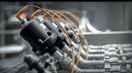
Válvulas de inyección de la dosificación
