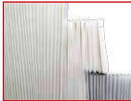
Les éléments filtrants sont traités avec de l'eau ultra pure, puis séchés par un flux d'air chaud et stérile.
