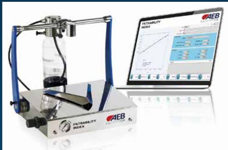
AEB 过滤指数仪 (AEB F.I.) 是一种全自动的精密仪器，用于分析葡萄汁，葡萄酒及所有液体食品的可过滤性。设备有USB接口，可与电脑连接，用于进行管控，分析，数据归档和打印检测结果。
