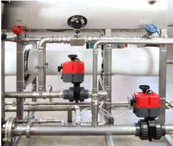
VALVOLE DI REGOLAZIONE MANUALI Consentono una gestione puntuale della pressione sulla membrana.
