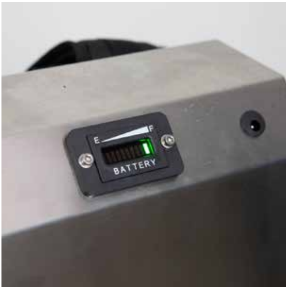
Segnalatore di carica della batteria a 220 Volt
