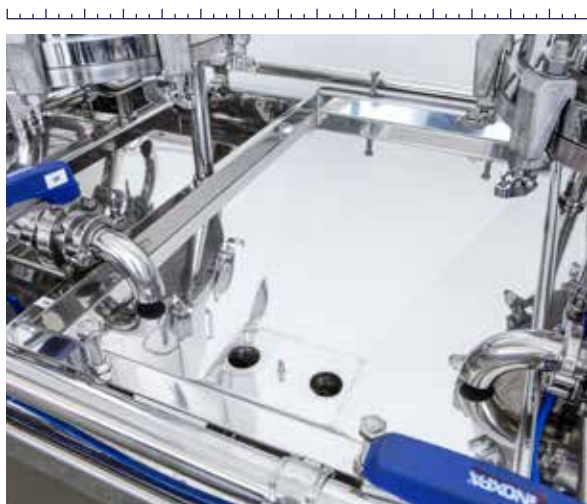
TISZTÍTÓ OLDAT TARTÁLYA SZINTJELZŐVEL
