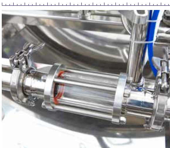
MEGFIGYELŐ ÁLLOMÁS A KIMENETI CSÖVÖN*
