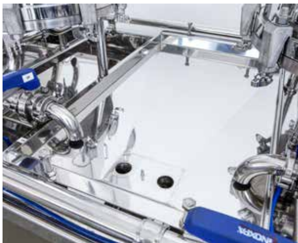
DEPÓSITO PARA SOLUCIÓN DETERGENTE CON CONTROL DE NIVEL
