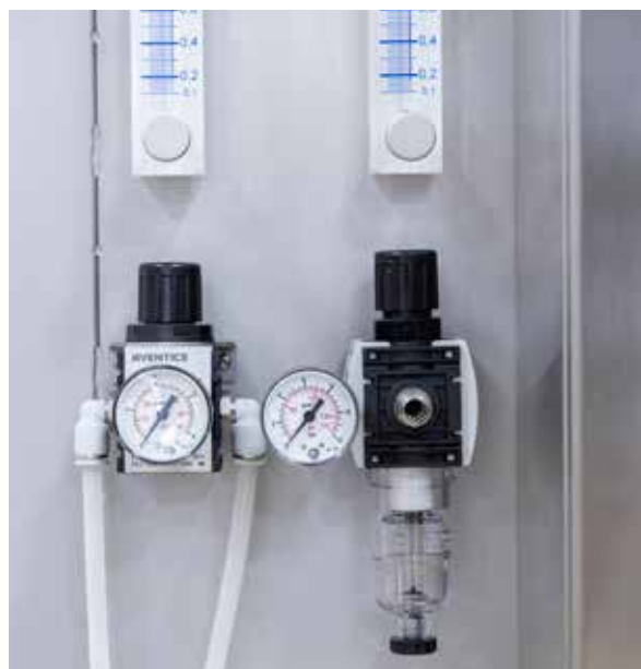
NITROGÉNKEZELŐ EGYSÉG, SZATURÁCIÓT SZABÁLYOZÓ MIKROMETRIKUS SZELEP, BIZTONSÁGI SZELEP NYOMÁSMÉRŐVEL ÉS MINTAVEVŐVEL
