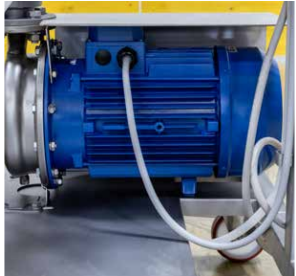
POMPE CENTRIFUGE SPÉCIFIQUE PAR FLOTTATION
