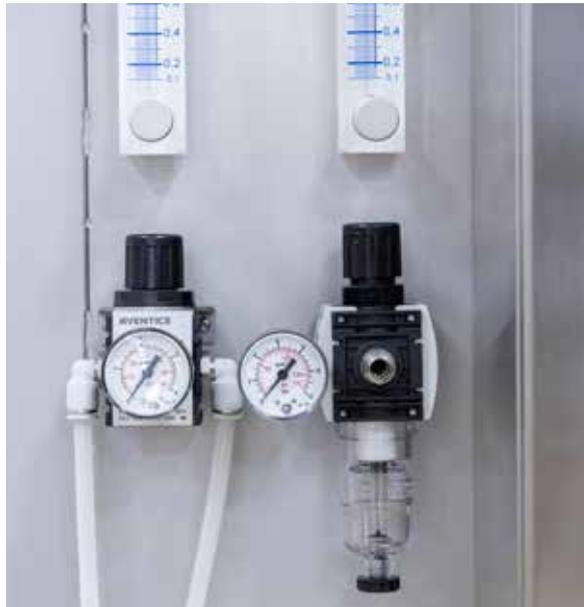
**GRUPO DE GESTIÓN DEL NITRÓGENO, VÁLVULA MICROMÉTRICA PARA LA REGULACIÓN DE LA SATURACIÓN, VÁLVULA DE SEGURIDAD CON MANÓMETRO Y RECOGIDA DE MUESTRAS**
