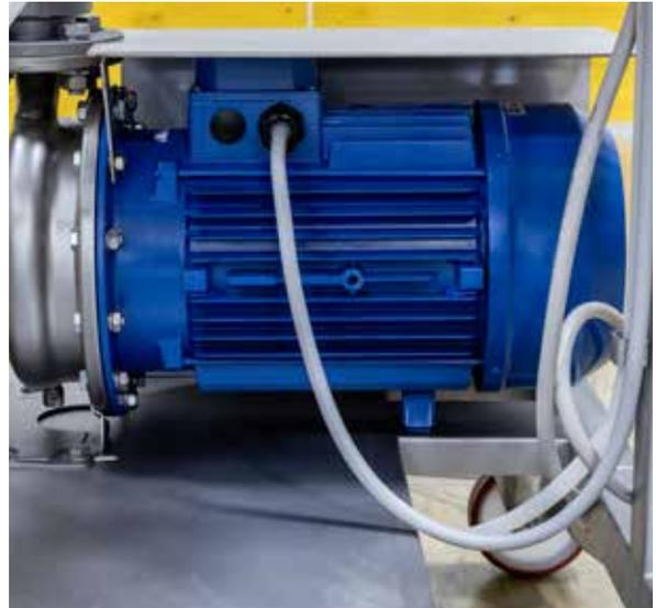
**BOMBA CENTRÍFUGA ESPECÍFICA PARA FLOTACIÓN**
