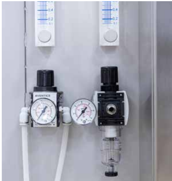
GRUPO DE GESTIÓN DEL NITRÓGENO, VÁLVULA MICROMÉTRICA PARA LA REGULACIÓN DE LA SATURACIÓN Y VÁLVULA DE SEGURIDAD CON MANÓMETRO Y SACAMUESTRAS
