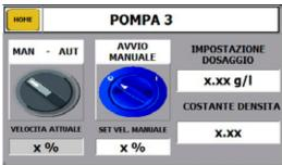
Grâce à un signal de la pompe d'écoulement du produit et en activant le sélecteur automatique, lorsque la pompe est mise en marche, elle dose automatiquement. Il est également possible de sélectionner un dosage continu si une dose ponctuelle est ajoutée.
