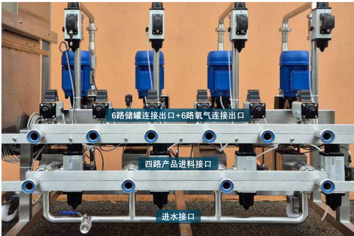
CTRL-TANK系列设备不同管路连接示意
