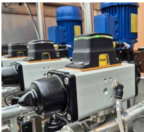
14 VANNES PNEUMATIQUES équipées d'un actionneur et d'un capteur de proximité
