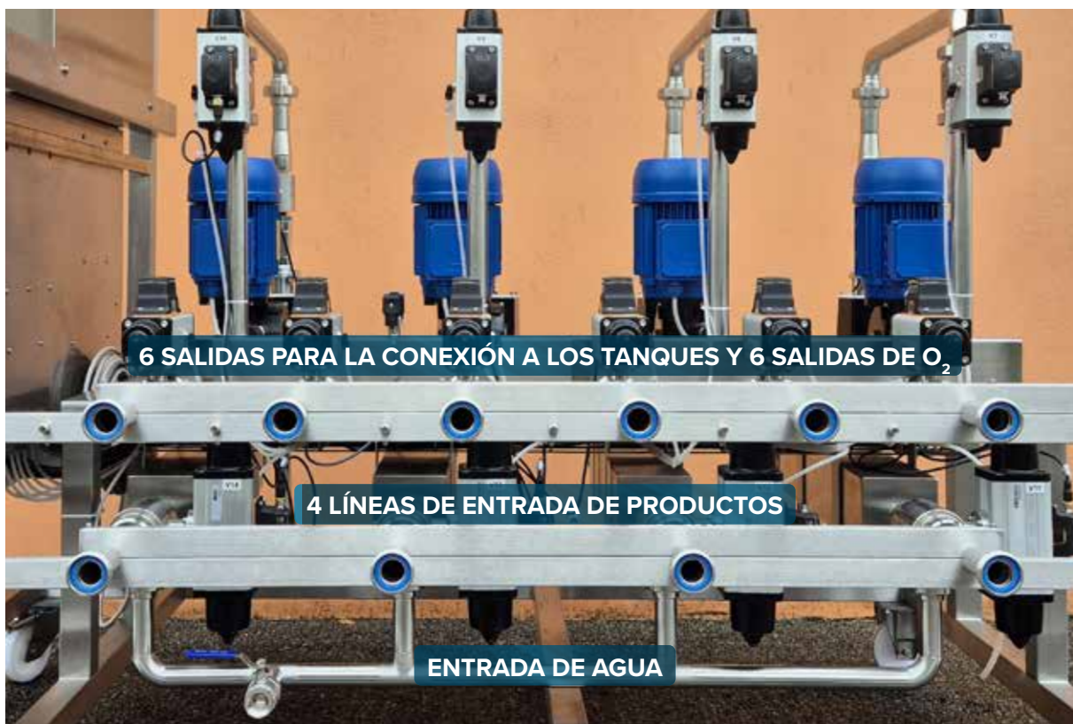
N. 1 VARILLA DE INYECCIÓN Y N.1 VARILLA DE EXTRACCIÓN para cada tanque gestionado, incluyendo un difusor de oxígeno
