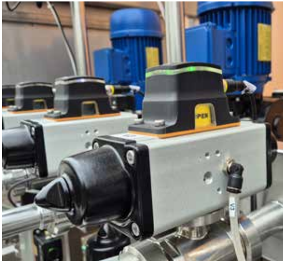
14 PNEUMATIKVENTILE mit Antrieb und Näherungssensor
