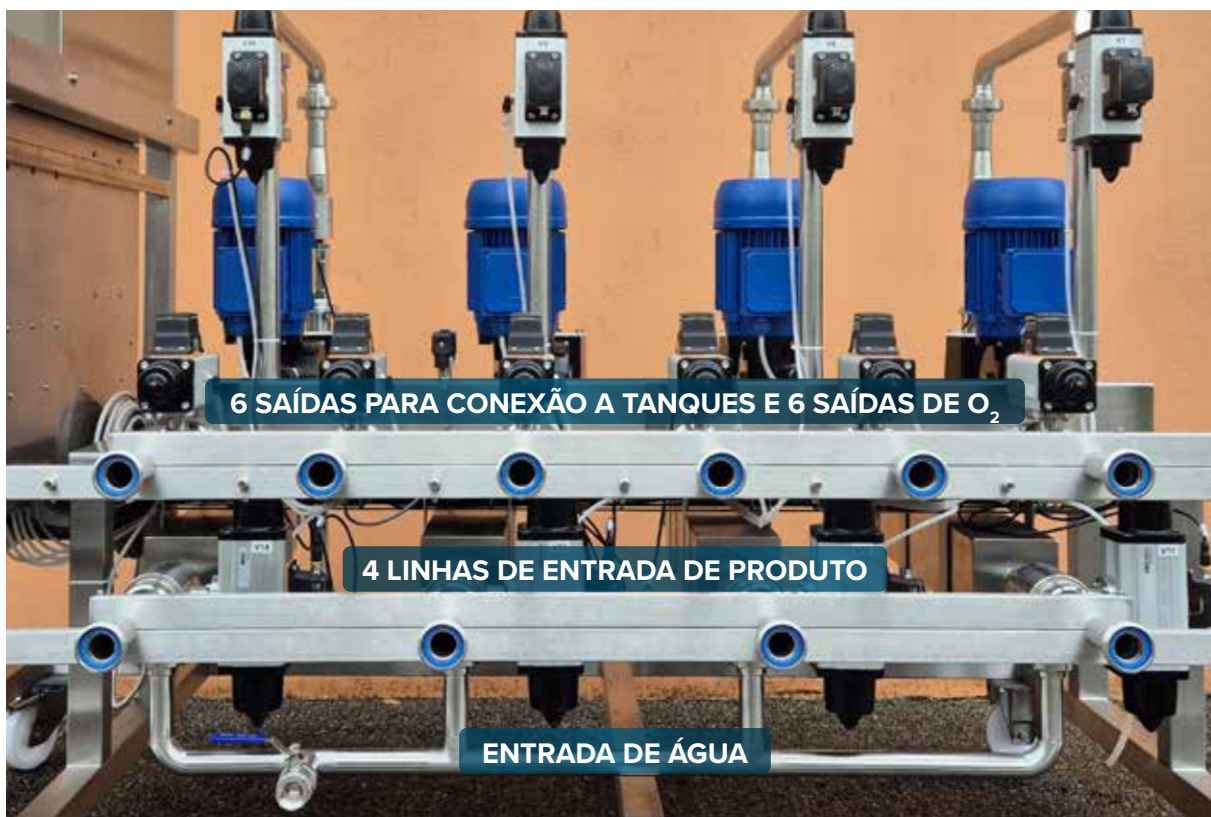
1 HASTE DE INJEÇÃO E 1 (UMA) HASTE AMOVÍVEL para cada tanque gerenciado, incluindo um difusor de oxigênio
