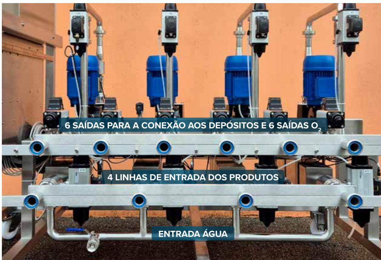
**6 SAÍDAS PARA A CONEXÃO AOS DEPÓSITOS E 6 SAÍDAS O<sub>2</sub>**
