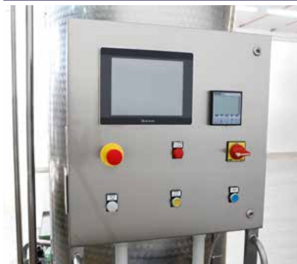
ELEKTROMOS KAPCSOLÓTÁBLA PH-MÉRŐVEL
