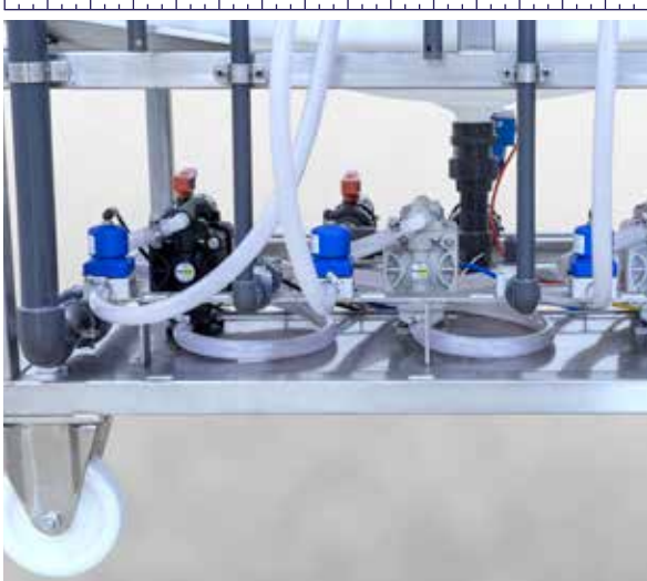
带安全阀的混合泵 考虑到清洁剂有危险性，需要使用带有专用安全阀的泵对流量进行控制。
