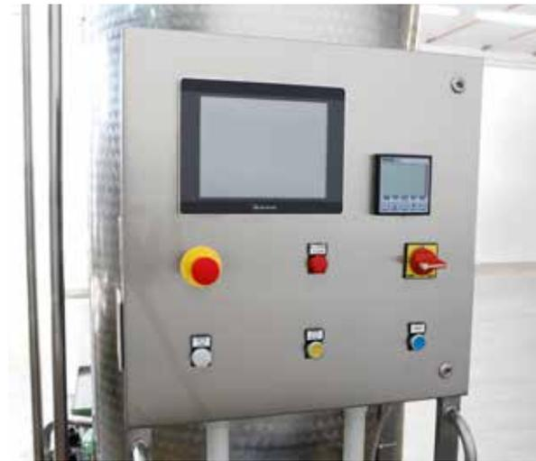
**QUADRO ELÉTRICO COM MEDIDOR DE PH**
