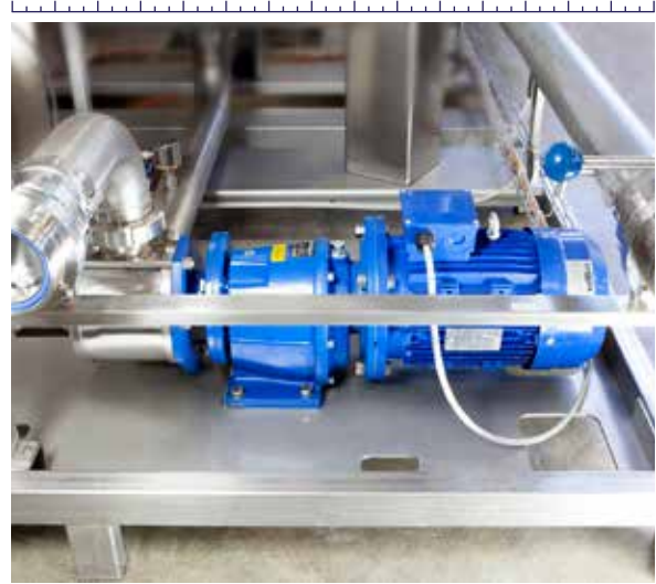
泵 橡胶低速叶轮对葡萄酒无伤害。
