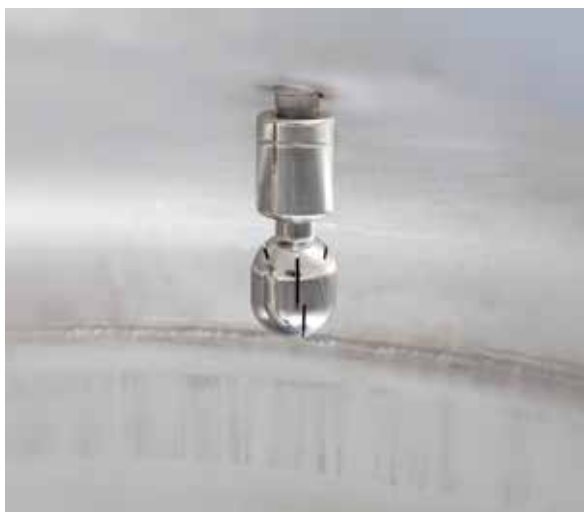
球式喷头 手动阀控制的两个球式喷头。
