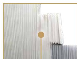
Gli elementi filtranti sono flussati con acqua ultra pura e quindi disidratati con flusso di aria calda e sterile.
