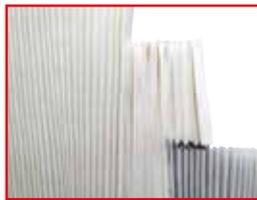
Die Filterkerzen werden mit besonders reinem Wasser gespült und dann mit einem heißen, sterilen Luftstrom dehydriert.
