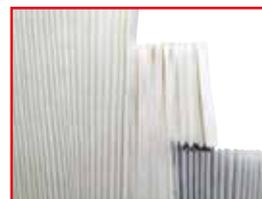
Die Filterkerzen werden mit besonders reinem Wasser gespült und dann mit einem heißen, sterilen Luftstrom dehydriert.
